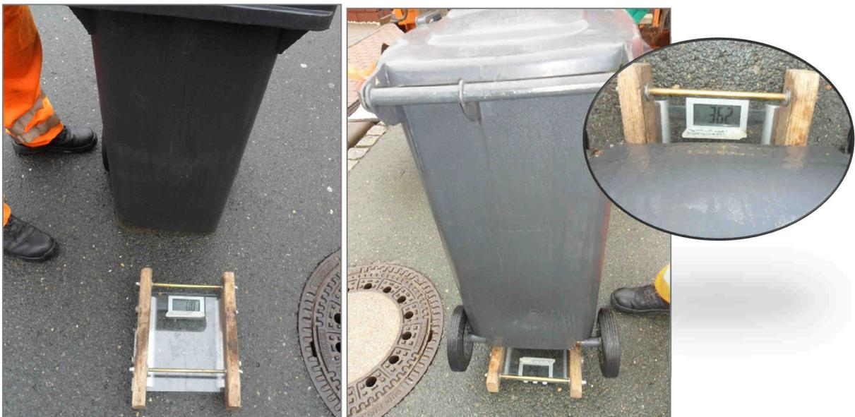
**Foto 5: Bestimmung des spezifischen Raumgewichtes eines 120 l Stichprobenbehälters**
