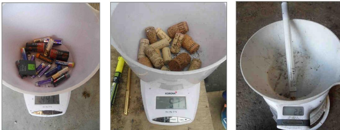
**Foto 18: Wägung leichter Sortierfraktionen mittels Haushaltswaage (Toleranz  $\leq 0,001$  kg)**
