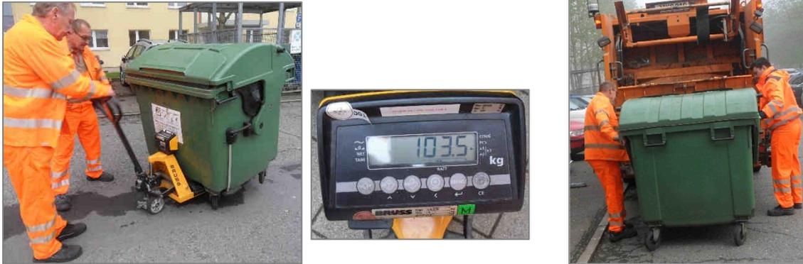
**Foto 7: Verwiegung eines 1,1 m<sup>3</sup> MGB und Stichprobenentleerung in das Sammelfahrzeug**
