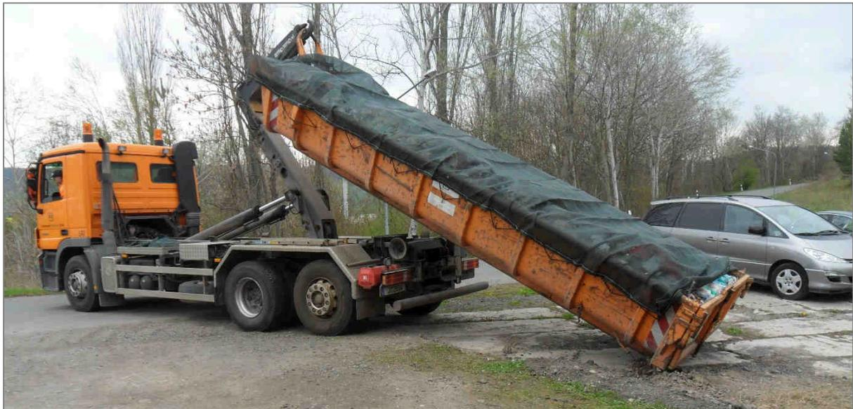
**Foto 19: Verkipfung sortierter Fraktionen und Abtransport des Sortiergutes**
